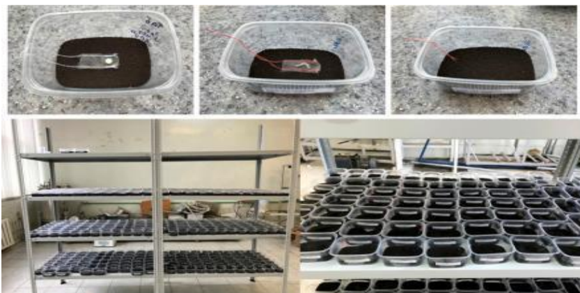
Рисунок 3.10 - Фото лабораторных почвенных микроэкосистем, в которых экспонировали и исследовали сконструированные препараты, затаренные в чехлы из мельничного газа
