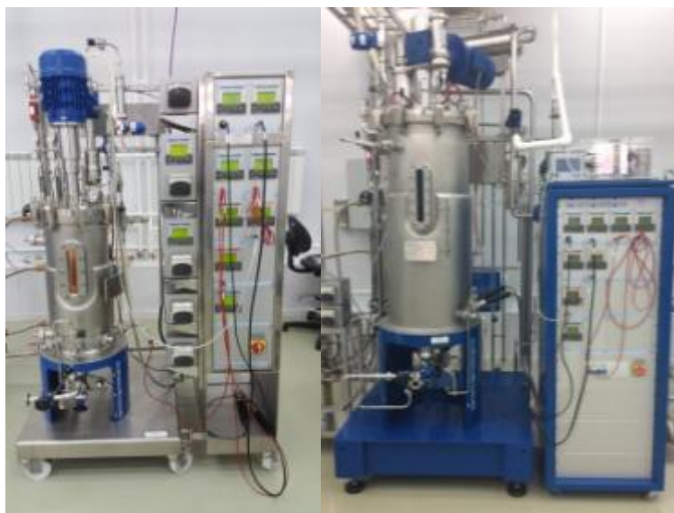
Рисунок 2.3 - Фото самостерилизующихся ферментеров («Bioengineering», Швейцария) объемом 30 л (слева) и 150 л (справа)
