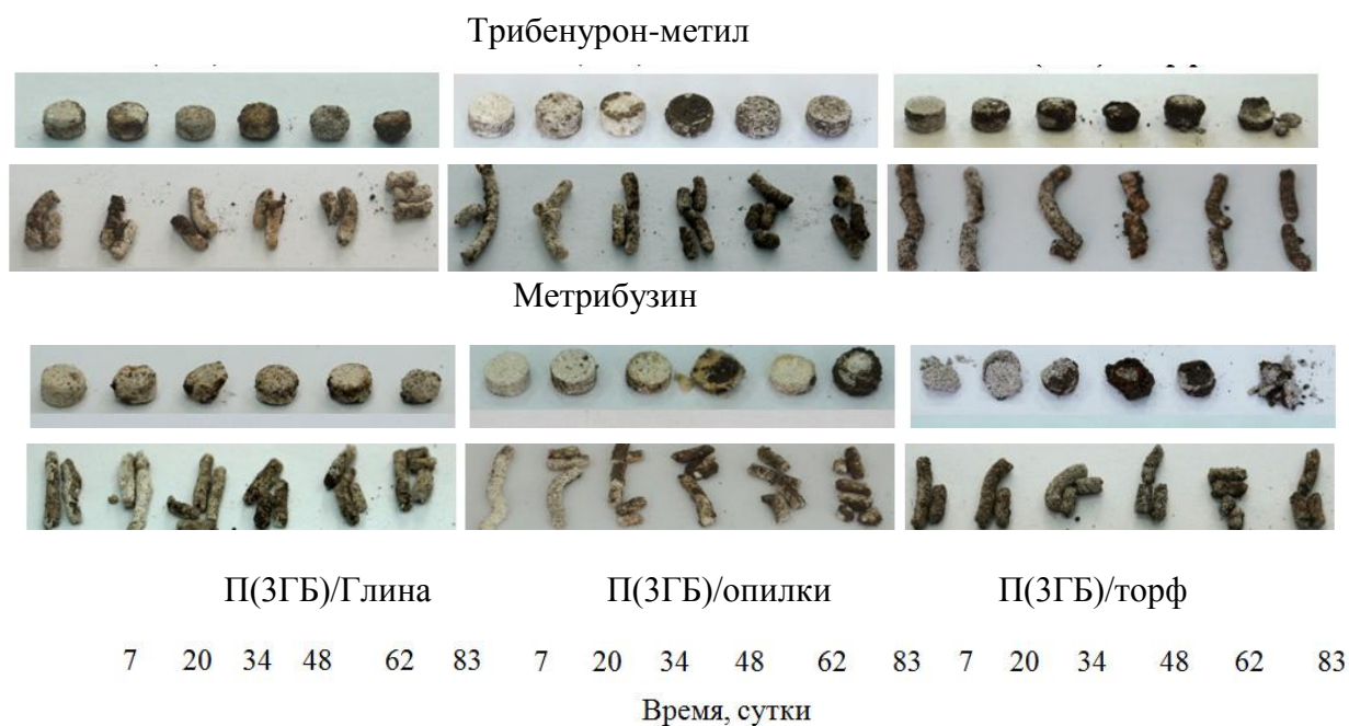
Рисунок 3.12 - Фото таблетированных форм и гранул, нагруженных гербицидными препаратами, в ходе разрушения при экспозиции в полевой почве
