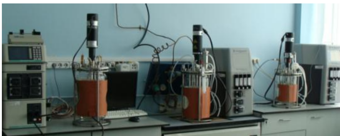
Рисунок 2.2 - Автоматизированные ферментационные комплексы BioFlo 110 и 115 «New Brunswick Scientific» (США); объем ферментеров от 8,0 до 15,0 л
